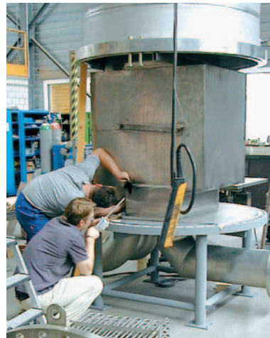
Inspeção de um catalizador industrial para 3000 Nm³/h com carcaça de 10 bar parcialmente elevada. Inspecting an industrial catalyzer for 3000 Nm³/h with 10 bar shell partially elevated.
