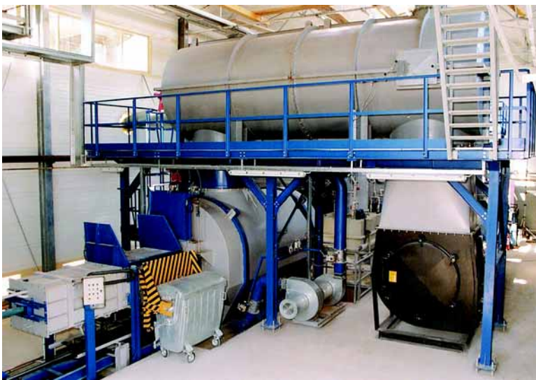
Usina de incineração com câmara de combustão estática para operação contínua (Capacidade de 50 a 16.000kg/dia) - Incineration plant with Static Combustion Chamber for continuous operation (Capacity range 50kg up to 16'000kg/day)
